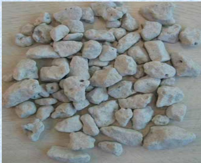
徐冷高炉スラグ粗骨材
