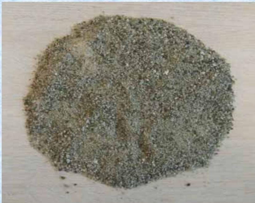
急冷高炉スラグ細骨材
